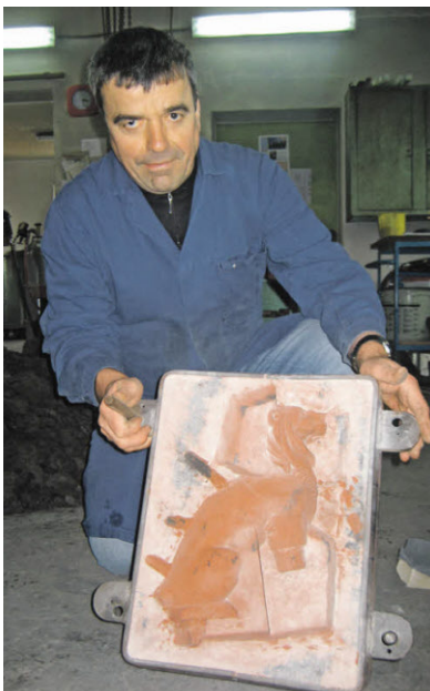
So sieht die Form aus, in die das heiße Aluminium gegossen wird. Bild: SN/MACK
