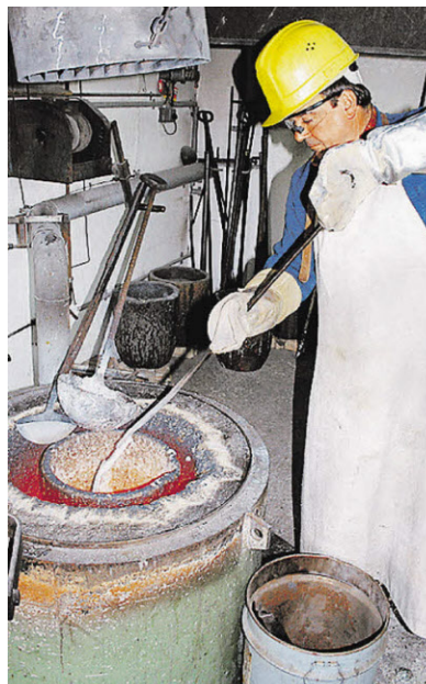
Auf 750 Grad Celsius wird das Aluminium im Tiegelofen erhitzt, dann . . .
