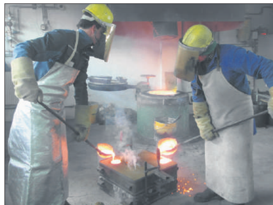
Thomas (links) und Franz Schipflinger beim Gießen von flüssigem Metall bei 1.200 Grad Celsius.
